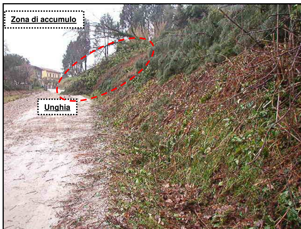
Foto n° 2 – accumulo di materiale su via Fonte con vegetazione arborea sradicata
